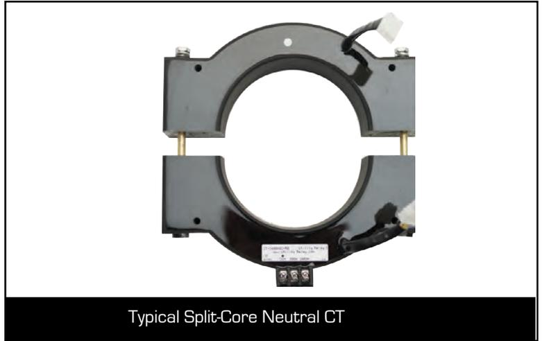
Utility Relay Company fabrica TC de núcleo dividido para su uso como TC de neutro en sistemas de 4 hilos. Los núcleos divididos facilitan la instalación del CT en el bus o cable existente. Cada núcleo dividido tiene placas fenólicas con perforaciones para adaptarse a tamaños/formas estándar de cables o trabajo de bus
