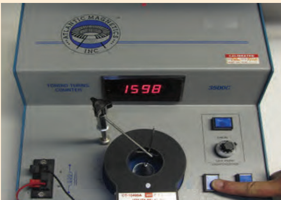
Comprobación del medidor de ocurrencias en unidades CT
